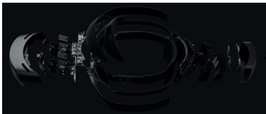
Vollgepackt mit Technik: In der MR-Brille befinden sich unter anderem ein Prozessor (Qualcomm), zwei IR-Kameras, vier Kameras für das Kopf-Tracking sowie ein 64-GB-Speicher.
