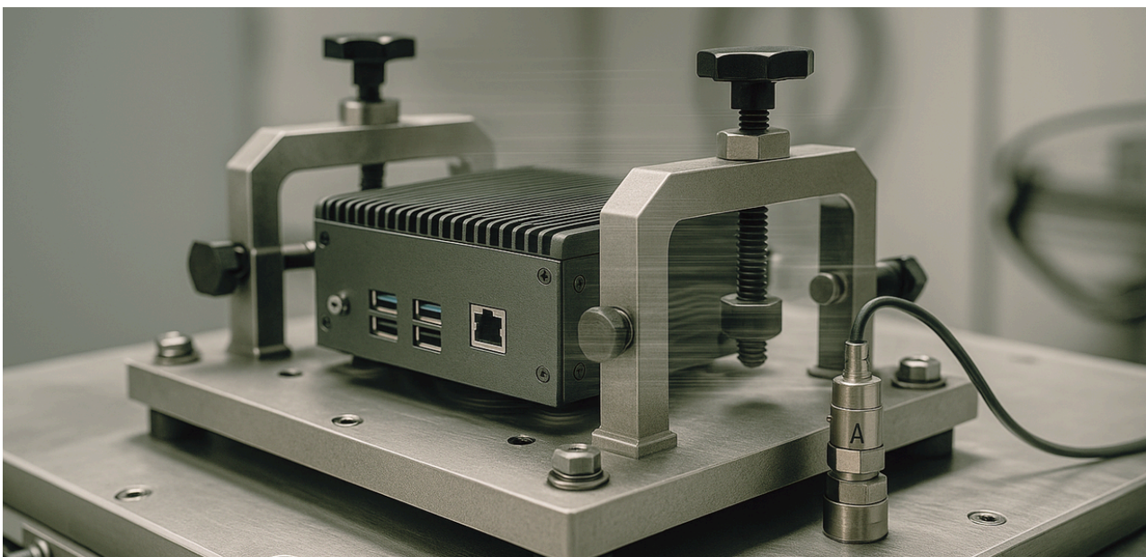
Mechanische Belastungstests sichern die Robustheit industrieller Box-PCs.
