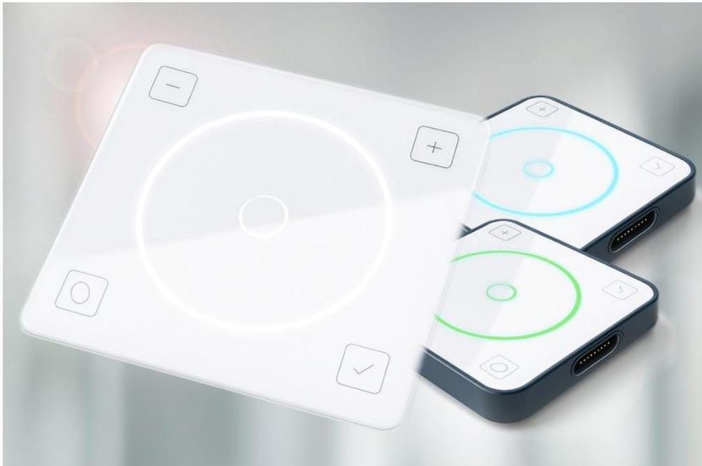
*Abdeckglas mit transluzentem Siebdruck zur LED-Hinterleuchtung*
